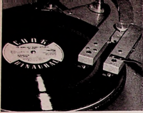
Fig. 45 - LIVINGSTON TOONARM voor binaurale reproductie van grammofonplaten
